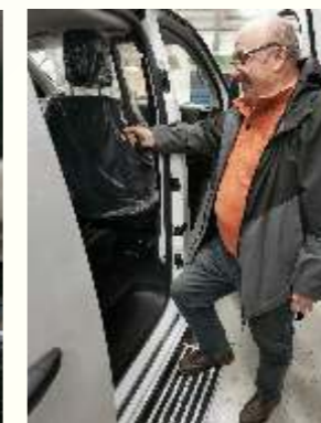
Automatisch ausfahrende Trittstufen bringen deutlich mehr Sicherheit beim Ein- und Aussteigen
