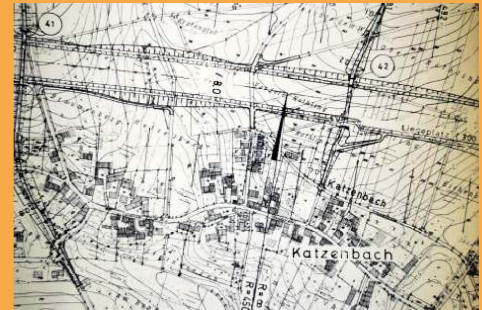
55 Meter breit und auf einer einheitlichen Höhe von 256 m ü. NN. Hier die Kanaltrasse unmittelbar am Nordrand Katzenbachs. (Rahmenentwurf des Wasser- und Schiffsamtes Saarbrücken vom 16.2.1970)
